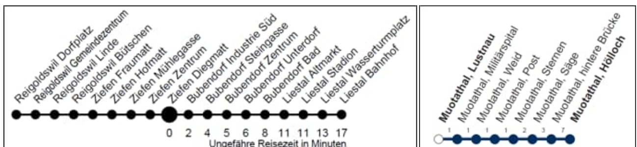
Abbildung 104: Beispiele von quer verlaufenden Perlschnüren mit kumulierten und einzelnen Fahrtzeitangaben / abweichende Symbole am Ausgangspunkt
