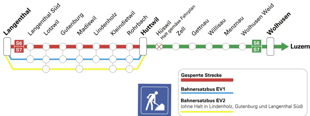
Abbildung 261: Beispiel Liniennetzplan Ersatzverkehr mit unterschiedlicher Haltepolitik. Diese Abbildung dient nur zur systematischen Erklärung der nachfolgenden Abbildungen.
